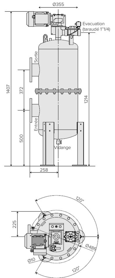
L'entrée et la sortie peuvent être tournées l'une par rapport à l'autre ( $180^\circ$ ,  $90^\circ$ ,...)
